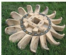
L'eau rentre par le haut dans une cuve de forme circulaire et entraîne les rouets qui transmettent une force de rotation à un arbre qui actionne les meules par un ensemble de transmissions par pignons.
